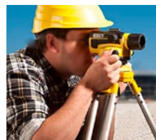
Niveau optique Peut permettre une mesure précise
