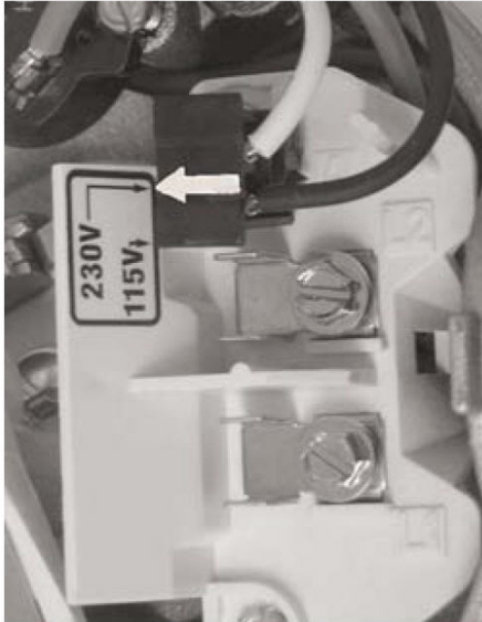
Interrupteur de changement réglé à 230 volts
