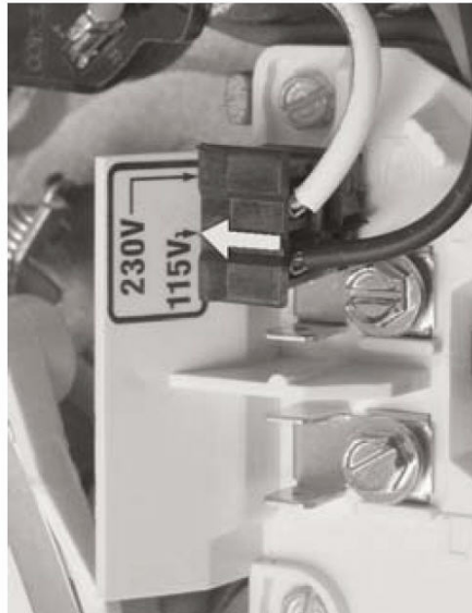
Interrupteur de changement réglé à 115 volts
