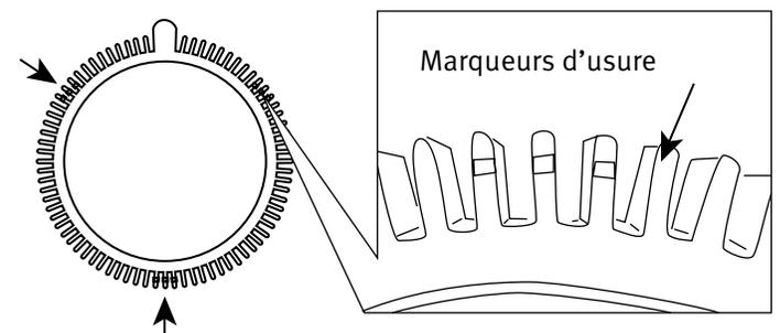
**L'UTILISATION DU NETTOYEUR LORSQUE LES PNEUS SONT USÉS POURRAIT ENDOMMAGER LA SURFACE OU LE REBORD DE LA PISCINE!**
