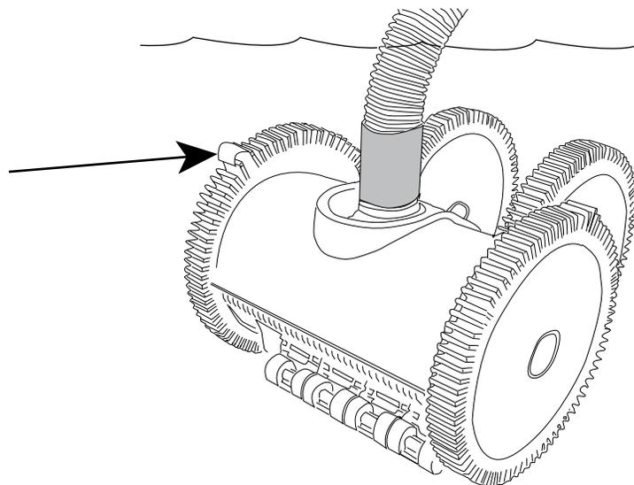
Une vanne de décharge régule l'aspiration de sorte que le nettoyeur ne dépasse pas les 11 à 14 tr/min (tours par minutes) optimaux. Pour ce faire, la vanne s'ouvre sur une conduite de décharge au besoin. Ceci assure le meilleur rendement possible pour votre nettoyeur.
